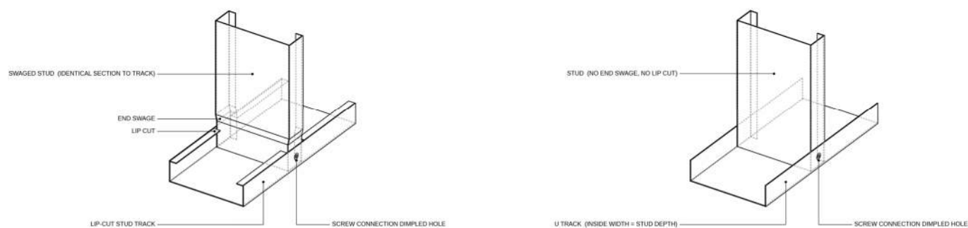
Figura 2 Los métodos de fabricación LGS en modo Panelizer y en modo híbrido
