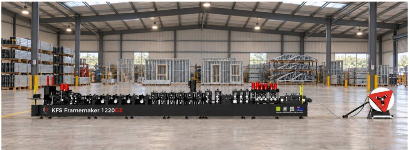
Figura 1 KFS Framemaker 1220G3 y desbobinador en un taller de estructuras de acero liviano
