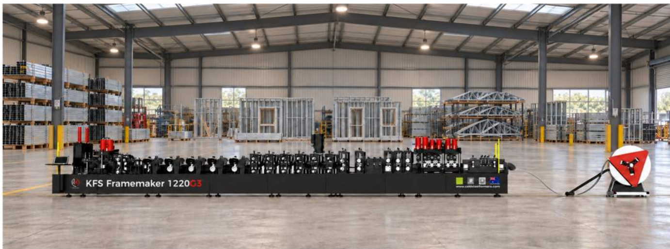
Figura 1 KFS Framemaker 1220G3 e svolgitore in un'officina di carpenteria in acciaio leggero
