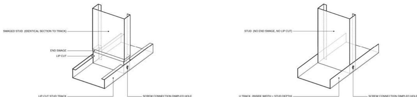
Figura 2 I metodi di fabbricazione LGS in modalità Panelizer e in modalità ibrida
